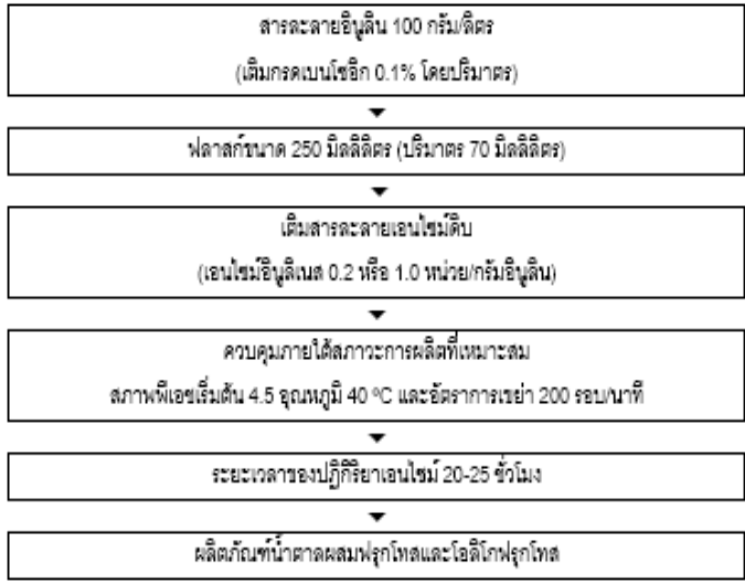
ภาพที่ 2 กรรมวิธีการผลิตน้ำตาลผสมฟรุกโทสและโอลิโกฟรุกโทสจากไซลิทอล ที่มา: สาขาวิชา และคณะ, 2548/53/54
